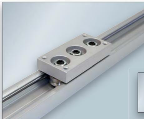
Le chariot dispose de trois galets dont 1 excentrique, ce qui permet de régler facilement la souplesse du déplacement selon les besoins de l'application.
